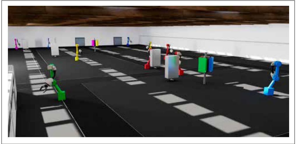
图3 包含5G联网固定机械臂和移动AGV的工厂车间示意图
