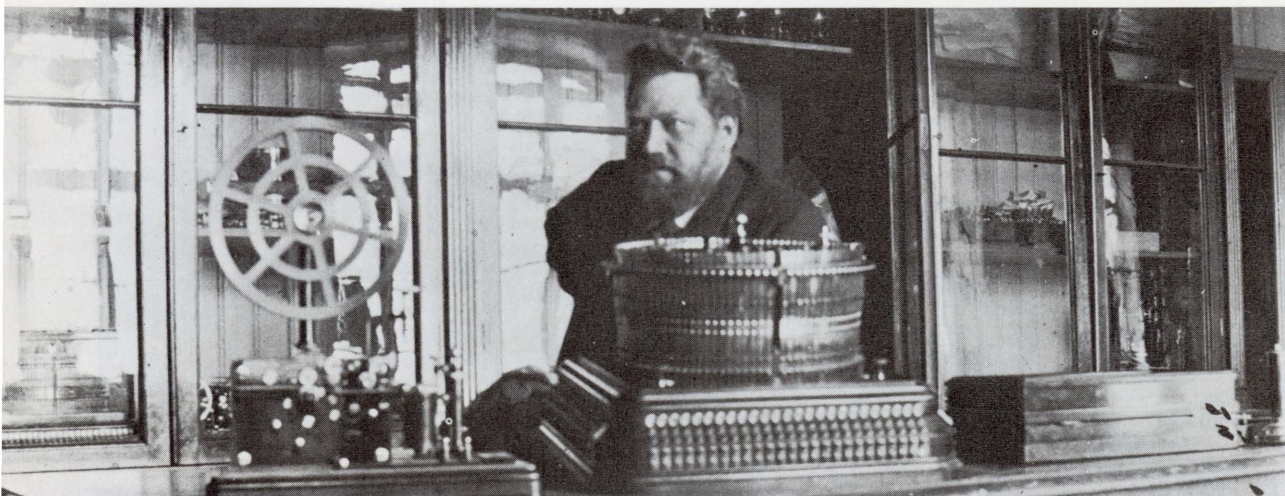
Lars Magnus Ericsson med en nollställningsutrustning till en automatisk växel. Tv en telegrafapparat.
