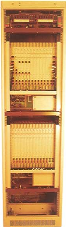
AXE-växeln minskar i storlek, i vissa delar ända upp till 90 procent.
