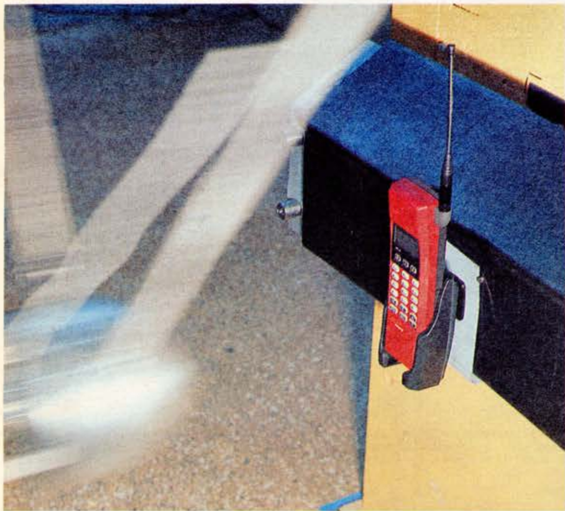
I 24 km/tim slår kulan emot biltelefonen. Ju mjukare den bromsas upp, dvs ju mer materialet fångar upp stöten, desto bättre. HotLine klarade testet.
