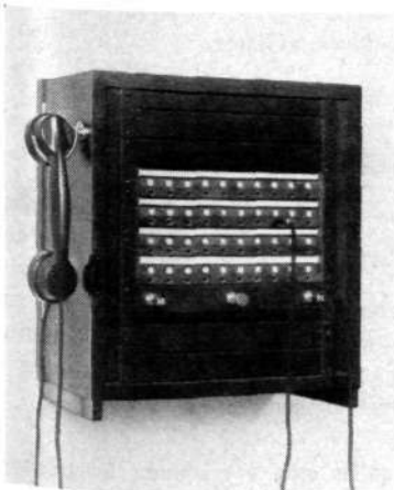
Fig. 1 Telefonväxel ADB 10 för 40 linjer utan interna samtalsmöjligheter
