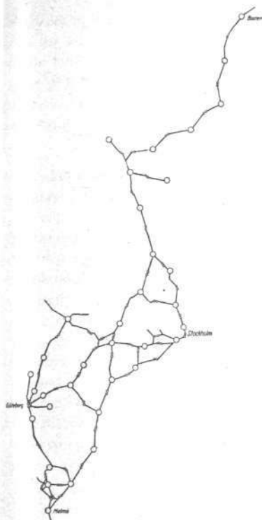
Fig. 6 Planerade och med selektorsystem utrustade krafttelefonförbindelser längs elektrifierade bansträckor ○ driftcentral med ledningsutrustning SLUA * gränstation med ledningsutrustning SLUB
