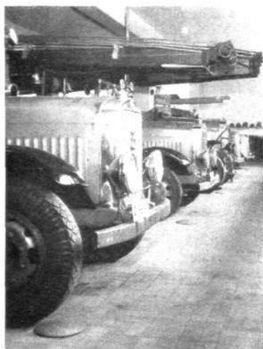
Fig. 8 Golvkontakter för utryckningskontroll framför bilarna i vagnhallen
