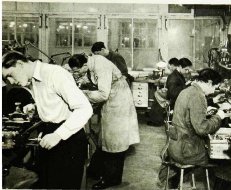
Interiör från lärlingskolan. T. v. syssla tre blivande mästare med svarvning. T. h. justering.
