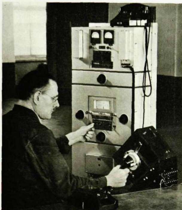
Bilder här ovan visar pressare Kurt Karlsson på Vta 12 i färd med att göra kåpor för elmätare, under det att provare Karl Larsson, Vta 30, på bilden t. v. kontrollerar de leveransfärdiga telefonapparaternas transmissions-egenskaper. På bilden nedan ses lackerarna Kurt Brink, Stina Söderström, Anna Westerberg och Henrietta Sjögren var och en i sin sprutbox ge färg åt några telefondetaljer på Vta 18.
