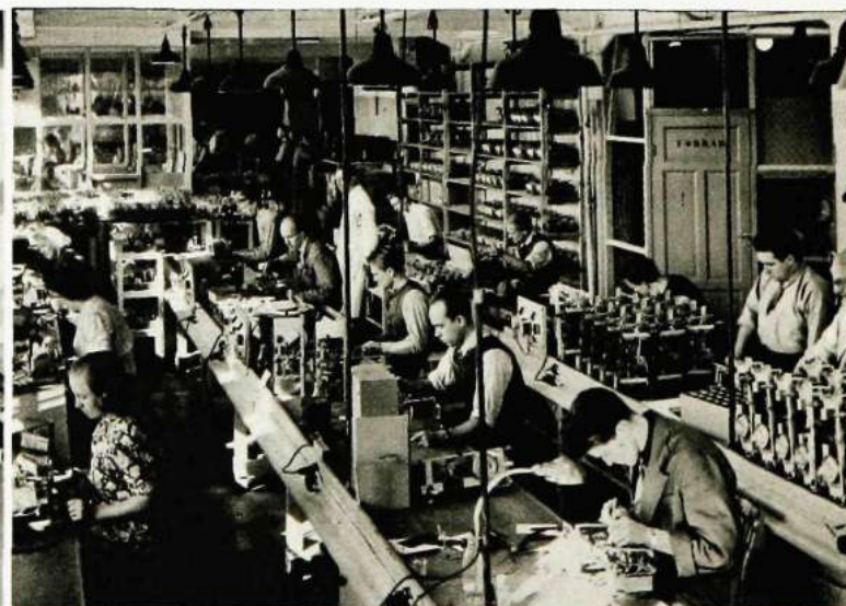
Här måste det från bild 2 färdiga chassier passera. Speciella provningsutrustningar underlätta perfekt kontroll. I bakgrunden gå de godkända chassierna vidare till lådisättningen.
