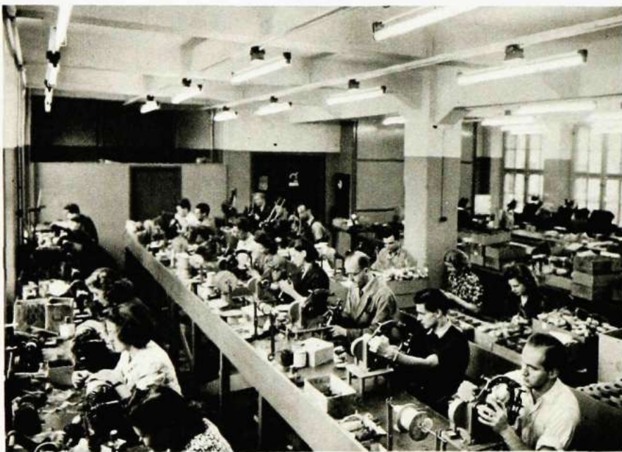
Detaljerna till Radiola tillverkas på olika specialavdelningar, provas, godkänns och gå sedan vidare till montage-hallarna. Modern lysämnesarmatur bidrager till ett gott precisionsarbete.
