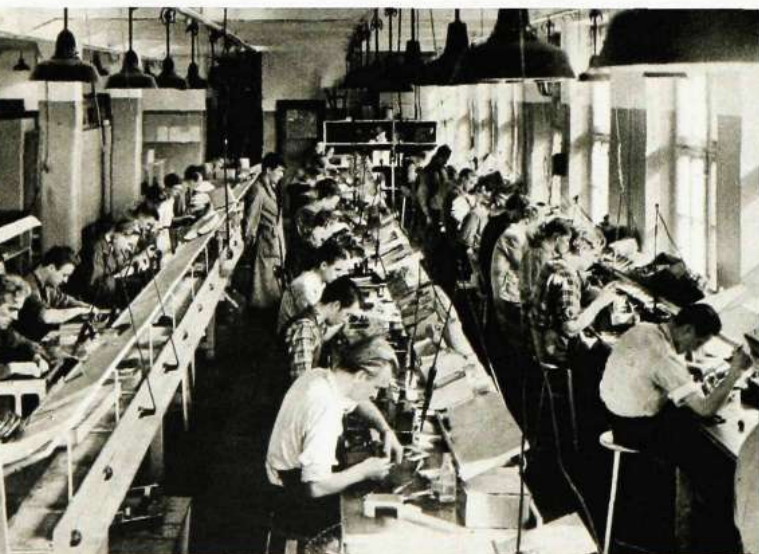
Från specialavdelningarna komma de godkända detaljerna eller enheterna till montagekedjorna. Montering sker efter löpande bandprincip. Bilden visar tre montagekedjor i verksamhet.
