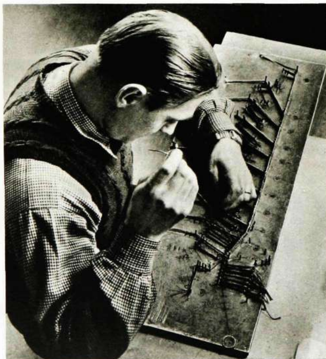
Ovan: hr G Gustavsson i förbindarverkstaden "syr ut" en kabel för en provanordning. T. h. en interiör från förbindarverkstaden.
