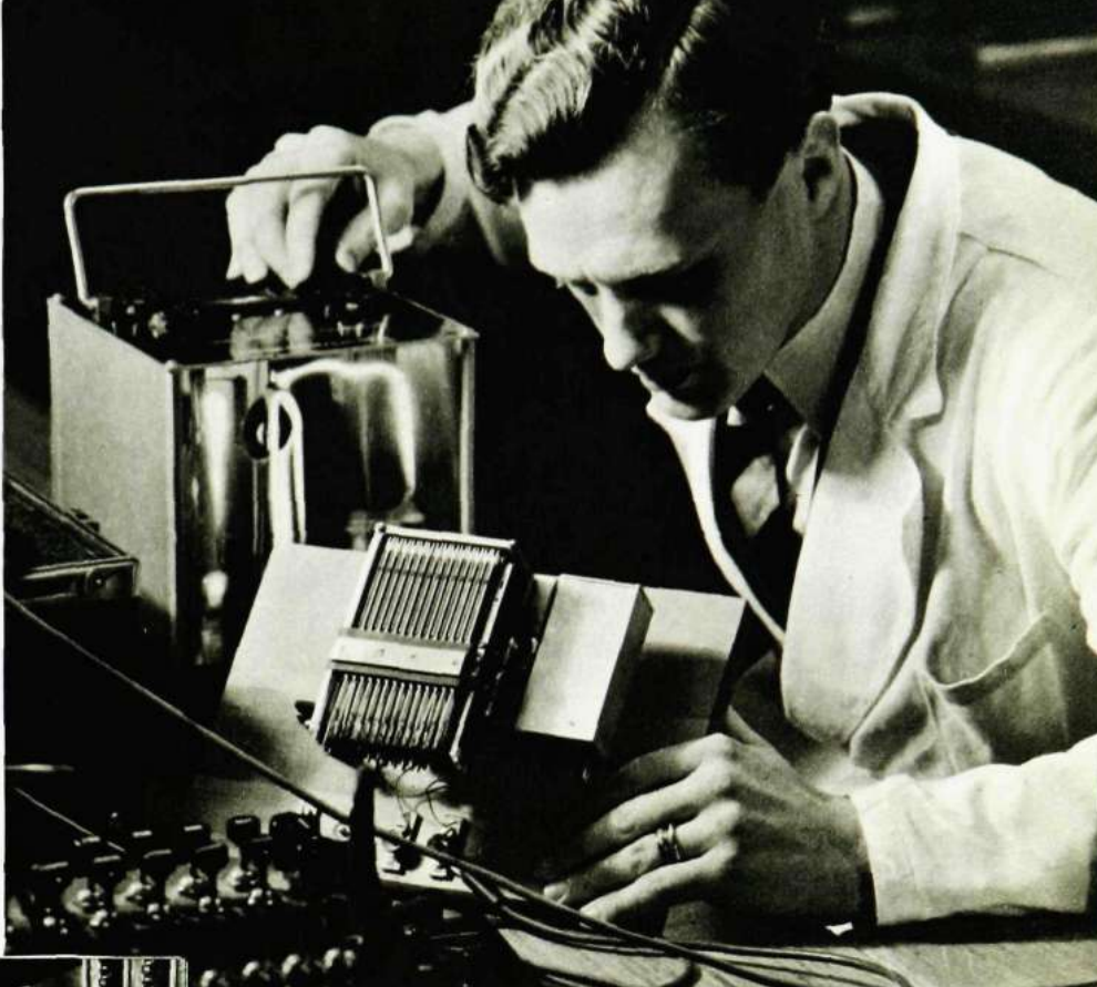
Ovan: ing. Å Svensson undersöker en kulväljare med hjälp av en strogboglow. T. v. ses ing. N Palmgren och K B Olsbro studera ett reläprov i långtidsprovrummet. Nedan ses herr J Jarl och ing. S Lindenhäll granska en 500-linjers väljare.
