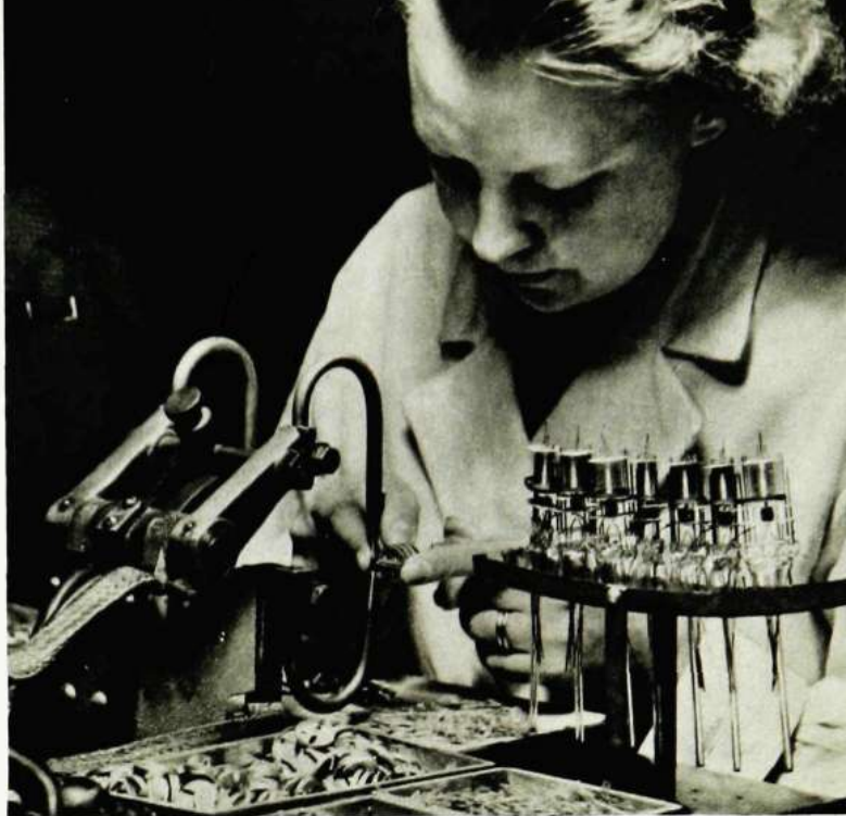
Punktsvetsning av radiatorer vid AB Svenska Elektronrör.
