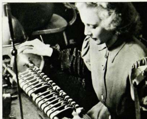
I den stora mätarsalen är bl. a. fröken Gun Johansson sysselsatt med att linda spänningsspolar, vilkas varvantal varierar mellan 2 000 och 26 000. Spolarna lindas samtidigt i grupper om 14 på ett gemensamt isolerrör, varefter de kapas, impregneras och transporteras till förrådet.
