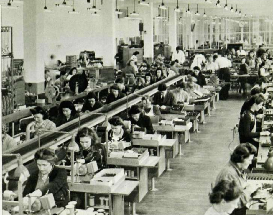
I ljusa, rymliga arbetslokaler sker hopsättningen av elmätare och elektriska mätinstrument. Kring transportbanden i elmätarsalen tillverkas strömspolar, räkneverk och andra mätardelar för att sedan via förrådet transporteras till huvudhopsättningen. Belysningen utgöres här liksom i de övriga verkstadsavdelningarna och ritkontoret av lysämneslampor.
