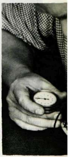
Fingerskivans hastighet prövas. Den skall »löpa ut» en impuls var tiondels sekund.
