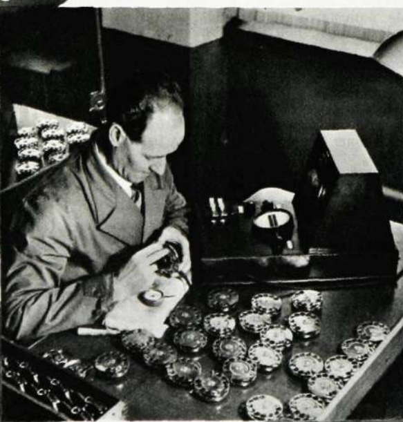
Impulserna kontrolleras med hjälp av detta instrument, som i dagligt tal kallas impulsmetern.
