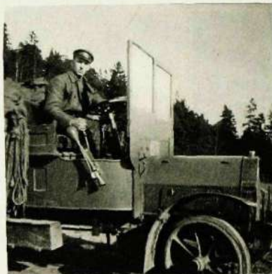
Ett steg framåt i utvecklingen. Hr Gustafsson lyckades få ett fönster och en plank, och av dem ordnade han en vindruta. Bilden är tagen 1924 eller 1925.
