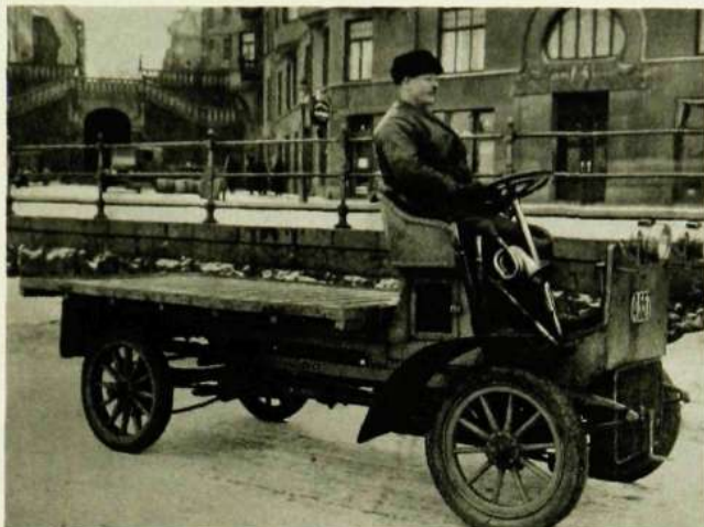
LM:s första lastbil, en schweizare av märket Arbenz. Motorn satt under förarsätet. Denna bil var byggd 1907, köptes 1908 och gick ända till 1924 eller 1925, då den skrotades. Motorn var emellertid fortfarande i användbart skick och köptes av en verkmästare vid LM. Mannen vid ratten är Knut Gustafsson. Bilden är tagen på Torsgatan, utanför gamla Norra stationen. De sista åren av vagnens »livsrid» brukade den ha en svans skolbarn efter sig.
