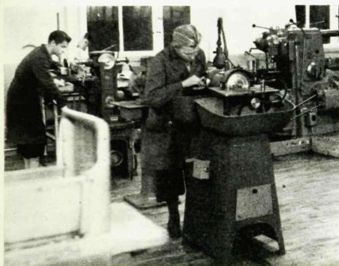
Här ses ett par representanter för den yngre generationen vid Söderhamnsfabriken sysselsatta med hårdmetallslipning (i förgrunden) och fräsning.
