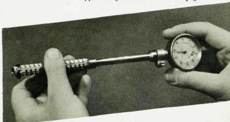
Närvarvaren för XY-väljaren är föremål för ytterst noggrann kontroll. Vid okulärbesiktning kontrolleras att detaljen är fri från grader. Med en ringtolk kontrolleras diametern på rörhylsan (bilden nederst t. v.) och med en mätlocka den invändiga diametern. (Bilden t. h.).
