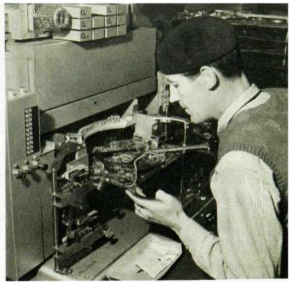
500-väljaren provas av Ivar Eklund, Vta 36, i en helautomatisk provpall, som gör en hel serie prov under 4 minuter. En lampplåsignalerar om någon detalj inte fungerar tillfredsställande.
