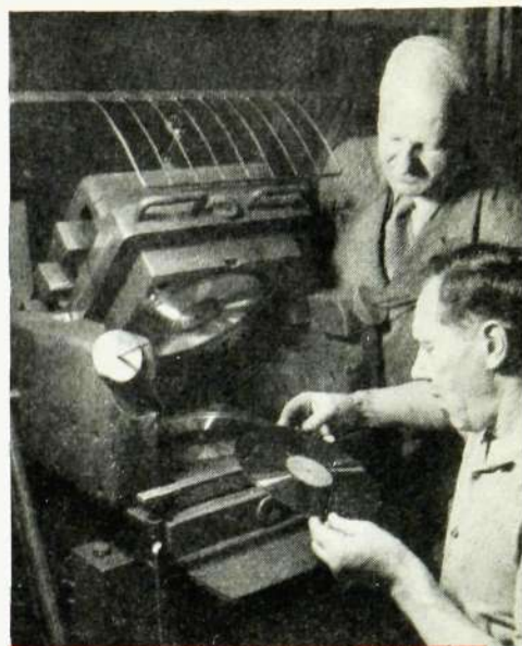
70 ton ger skivan ton. Josef Dratz tar ut den färdigpressade skivan, medan förman Valentin Julin ser på (ovan). Nedtill t. v. kommer Bror Generud med en stapel skivor till fru Margit Menker som i sin maskin ger kanterna en avslipning. Ing. Sven Åkesson övervakar på bilden bredvid fru Lilja Lorents inpackning av skivorna.
