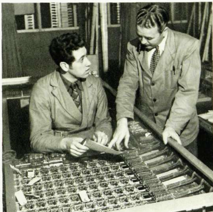
Det är många kabelknippen som ingår i ett XY-stativ. Lödpunkterna uppgår till över 1 000. Här går förman Helge Löf tillsammans med Hans Ödeen igenom kopplingschemat för att se om alla trådar ligger som de ska.
