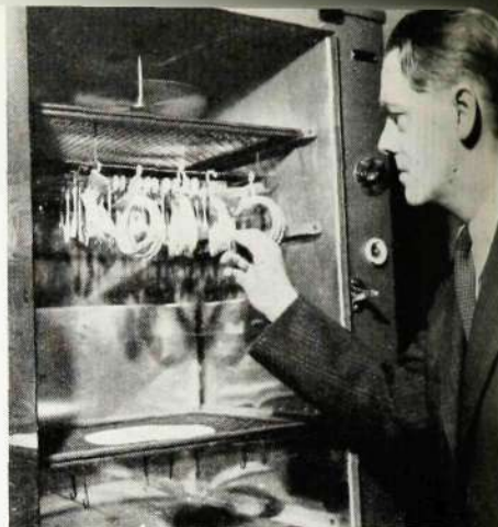
Chefen för plastlaboratoriet vid Kabelverket i Älvsjö, ingenjör Nils Eriksson kontrollerar några plastdelar, som undergår »tropiska prov» i ett värmeskåp.
