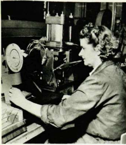
Med hjälp av luft mäter fröken Emy Andersson tjockleken på de plåtar som bildar kärnan i elmätarna.
