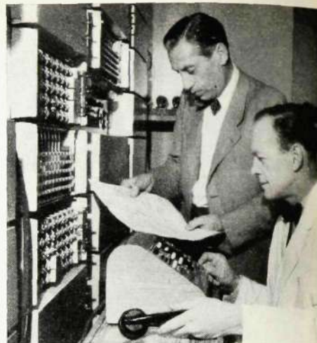
Ingenjör Eric Larson har svarat för konstruktionen av Spårvägens telefonväxlar. Här ses han tillsammans med sin medhjälpare, ingenjör Tore Larsson vid ett provstativ för denna anläggning.
