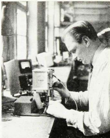
Arne Lundqvist gör mellanfrekvensprovning på Radiola-mottagare.
