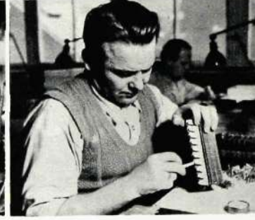
August Sausins har hållit på i fyra år med att justera ankare på multipelkopplingsreläer.
