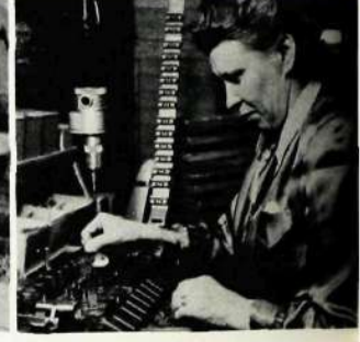
Fru Gerda Johansson monterar fjädergrupper med hjälp av en fixtur.
