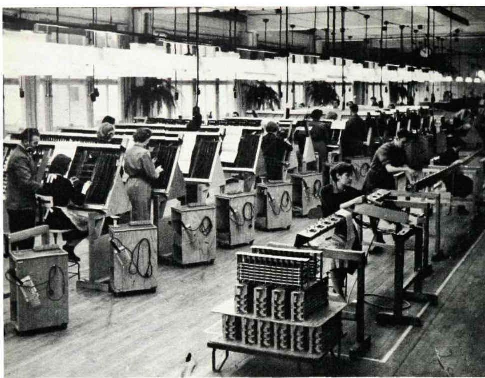
Interiör från Vt 22, som svarar för tillverkning av koordinatväljarstativ.
