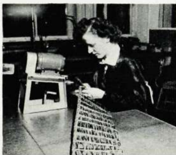
Fru Ely Johansson skalar av isoleringen på trådändarna.
