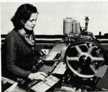
Fröken Ragnhild Petterson nitar fast kontakter i en specialmaskin, som är konstruerad och tillverkad på L.M.
