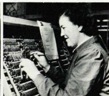
Fru Hilda Johansson är en av veteranerna på avdelningen, som hela tiden hållit på med att koppla och löda stativ.
