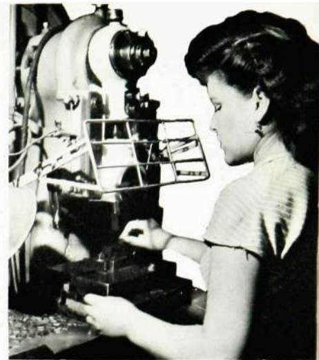
Gallergrindar, som fälls ner samtidigt med att pressen ullöses, är ett effektivt medel för att minska olycksfallen. Genom att använda skyddsglasögon förhindras, att svåråtkäta ögonskador uppstår.
