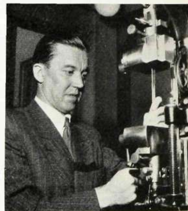
I en dragprovare kontrollerar ingenjör Rune Axenborg att ett prov från ett inkommet råvaruparti fyller de krav LME ställer.
