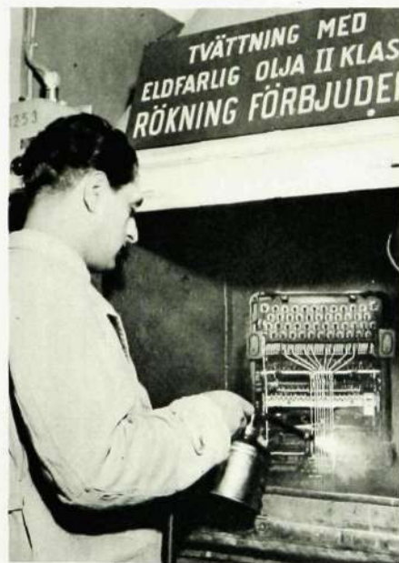
Kontorsmaskinerna skruvas isär och varje del tvättas i varnolen. På bilden tv besprutas en skrivmaskins underrede av herr Allan Seiden.
