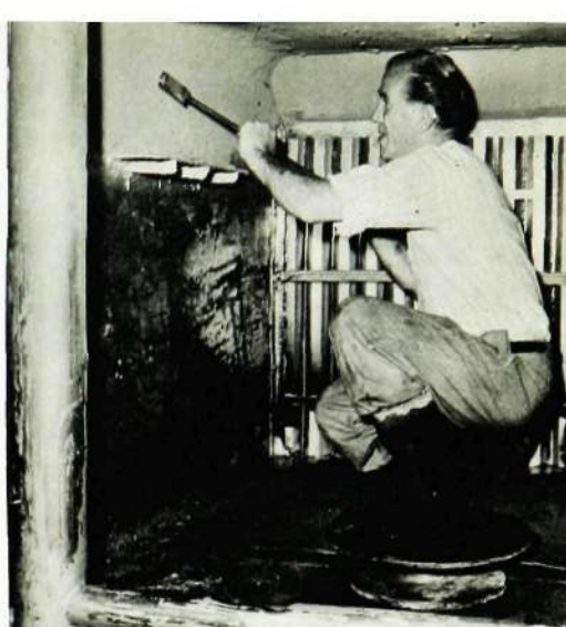
På ytbehandlingsavdelningen svarade Knut Eriksson för en grundlig storrengöring. Alla sprutboxarna skrapas rena och i förnicklingen plockade han bort allt det skräp som fallit ner under trallarna — det rörde sig om ca 100 kg skrot.
