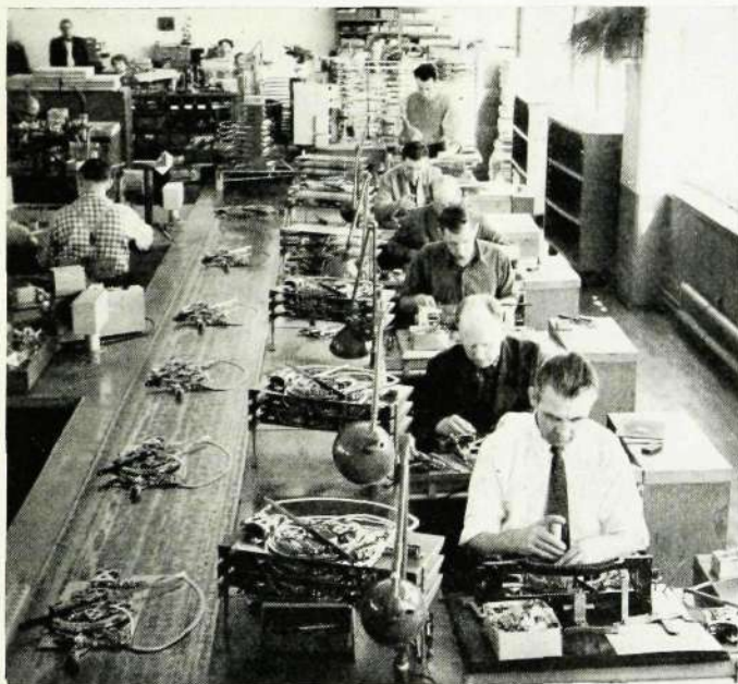
I stället för fingerskivetillverkningen får Söderhamnsfabriken hand om produktionen av 500-väljaren och av multipelmattorna, vars montering nu ligger på Huvudfabriken — 500-väljaren på Vt 36, där arbetsbilden är tagen.
