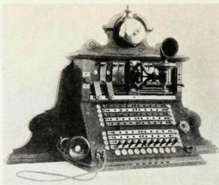
Denna växel av LM:s tillverkning, en s. k. skenväxel med kopplingskenor och lösa proppar för 10 linjer, användes ännu i början av 1890-talet.
