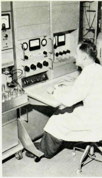
Med en transmissionsmeter utför ing Nils Ek, T3d, förstärkningsmätning på en koaxialförstärkare.
