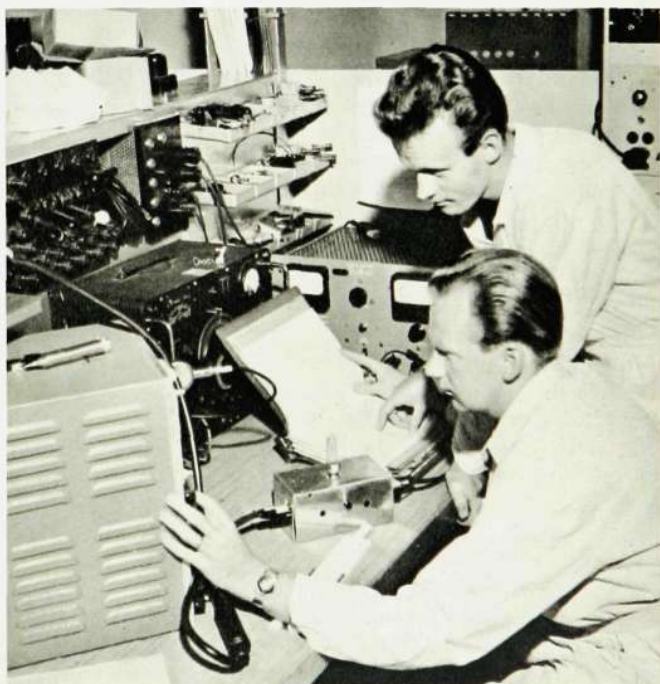
Ing. Lars-Gunnar Kristerson, T2ad, visar praktikanten Berndt Magnusson hur man utför impedansmätning på en kvartskristall.
