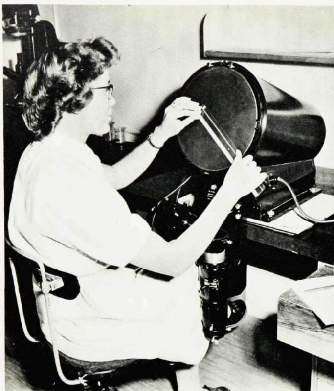
Shadowgraph kallas den här apparaten, som frk. Elsa Gustafsson, LK, använder för att mäta tvärsnittet på kablar. Tyvärr kan man inte på bilden se hur kabelns detaljer framträder på visirskivan, där mätningen sker.
