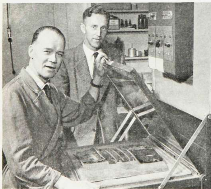
Ing. Tage Samuelsson och förman Sven Eklund, Tellus, ljusöverför ledningsmönster via fotonegativ på skiktet i kopierskåpet.
