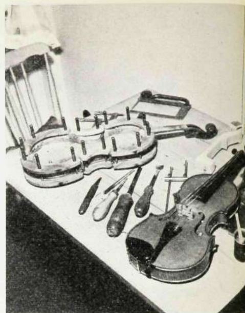
En fiol är klar och en annan har just fått botten fastlimmad. För övrigt syns en del av förman Gustavssons verktyg som behövs för fiolbyggeri.
