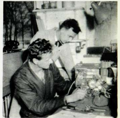
Provrummet är den sista anhalten för produkterna på deras väg till distribution. Ing. Hans Holgersson (provrumschef) och »veteranen» B Larzon kontrollerar att en bandspelare är fullgod.
