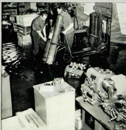
Verktygsarbetarna J O Bengtsson och Y Larsson torkar verktyg med gaslåga.
