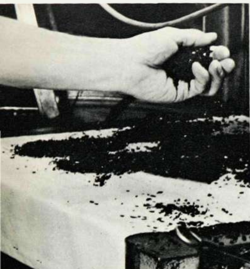
Som en handfull grus ser materialet till en grammo-fonskiva ut. Numer görs plattorna av PVC-massa (polivinylklorid) — den sista shellackplattan pressades i midsomras Massan värms först upp på ett bord . . .
