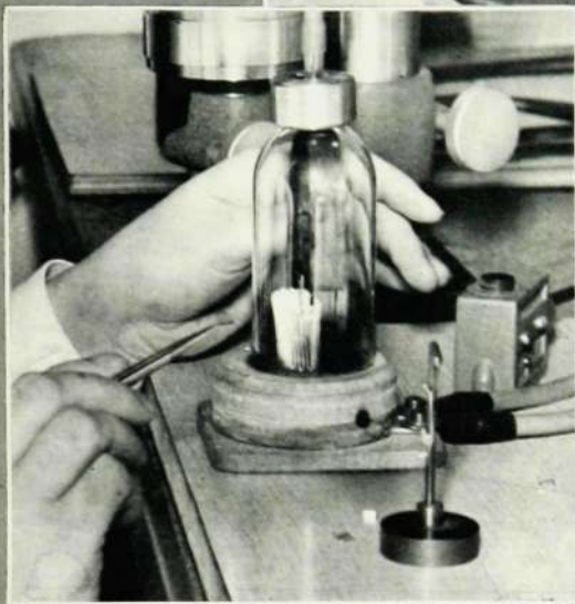
Mikrojobb III: Urgasning och förgyllning av ramgaller i vätgasklocka.
