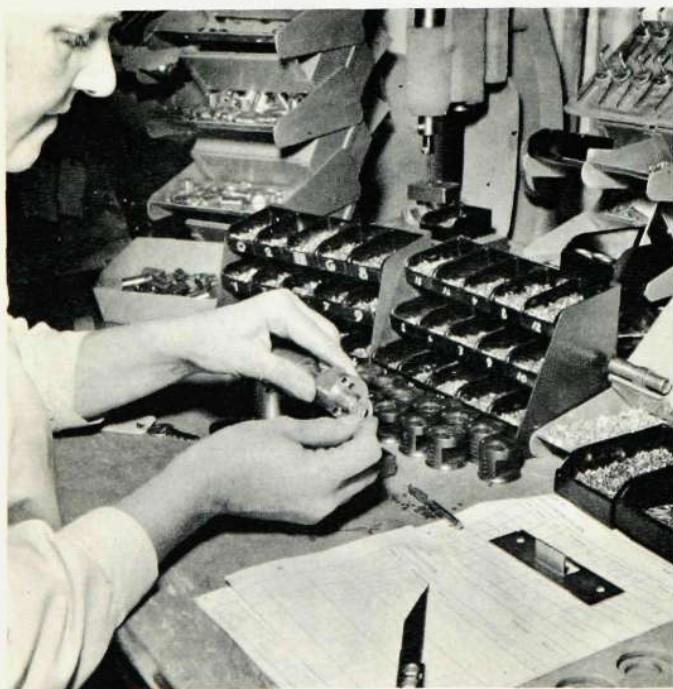
Mycket av låsarbetet är rent handarbete. Fru Ingrid Lindberg kombinerar de olika låsen i ett låssystem.
