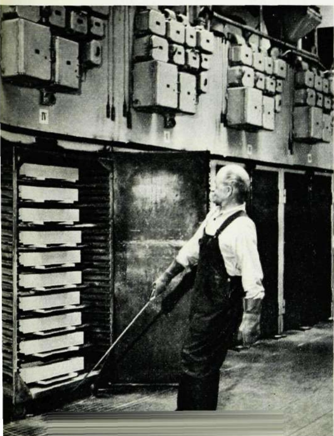
Bilden t v: Arvid Wallin laddar lackeringsugnarna med detaljer. Bildraden t h: Överst Emil Utas, en av de få på Vt-18 som använder pensel när han målar. Därunder studerar förman Gunnar Lundin en del lackeringsprover. Nils Olsson »lackerar» genom att trycka enligt silk screen-metoden. Nederst kontrollerar fru Emy Willing en leverans.
