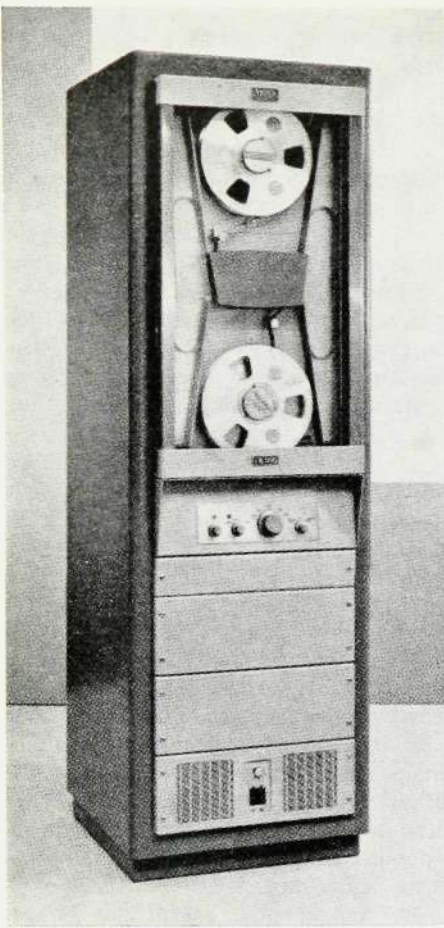
För att effektivt kunna utnyttja elektroniska datamaskiner fordras att data med stor snabbhet kan läsas in i och matas ut ur maskinen. Detta uppnås med magnetband, där data markeras i form av små magnetiska punkter. Bilden visar en s. k. magnetbandstation av det slag som Ferranti-Orion maskinen använder sig av och som har en läs/skrivhastighet av 90 000 tecken per sekund.
