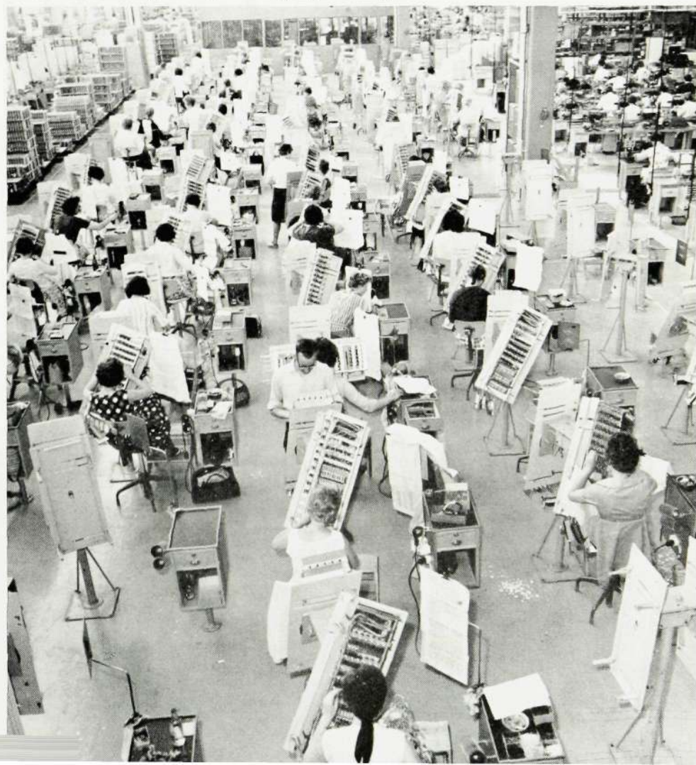
Interiör från förbindningsavdelningen där koppling och lödning av reläsatser sker.
