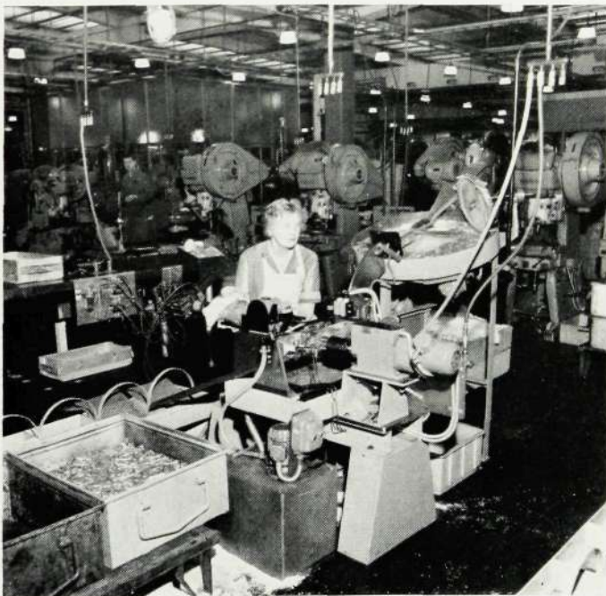
Så här blev arbetsplatsen efter förbättring. En helt ny maskin konstruerades och följden blev en »riktig» arbetsplats. Dessutom kan nu vederbörande sköta två maskiner, varför vinsten blev betydande både ur bioteknologisk och produktionssynpunkt.
