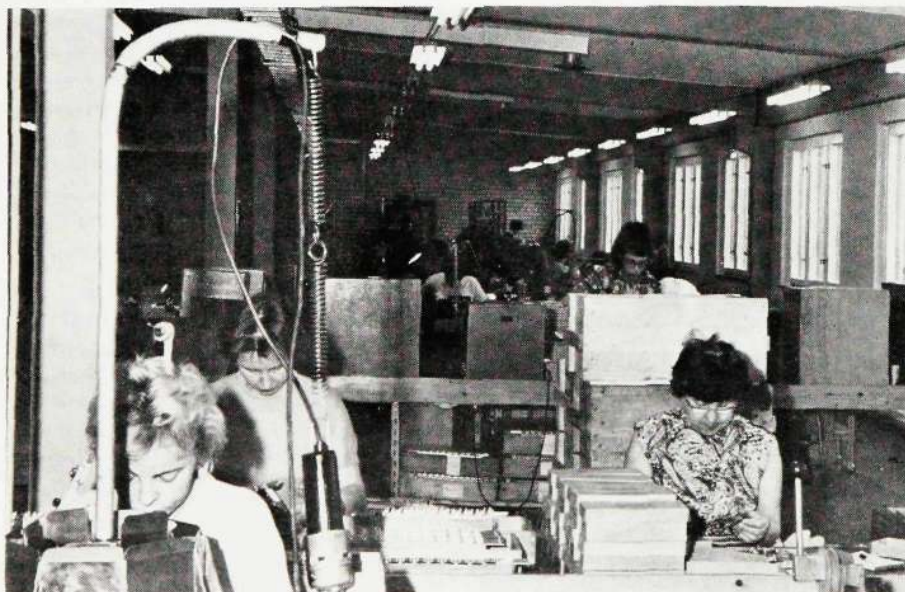
Interiör från nya verkstaden. Samtalsräknaren monteras här på band.
