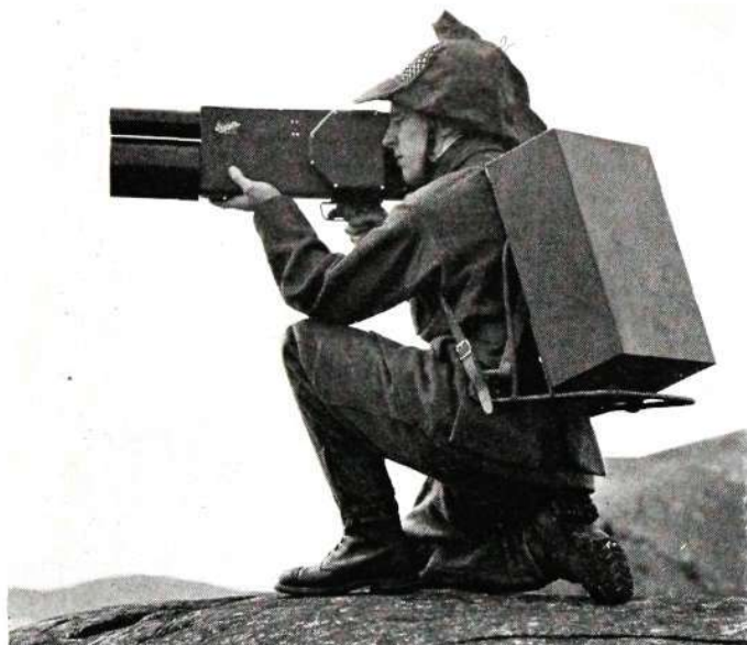
Avståndsmätning med LME-lasern. Nedan laser-geväret med locket borttaget.
