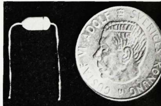
Kisellikriktaren A 13 är som synes inte stor. Den får ledigt plats på en enkrona.
