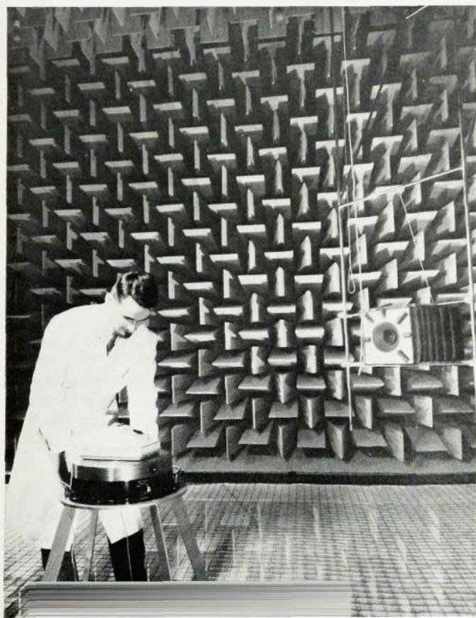
Mätningar av L M Ericssons högtalande telefon Ericovox i tysta rummet.
