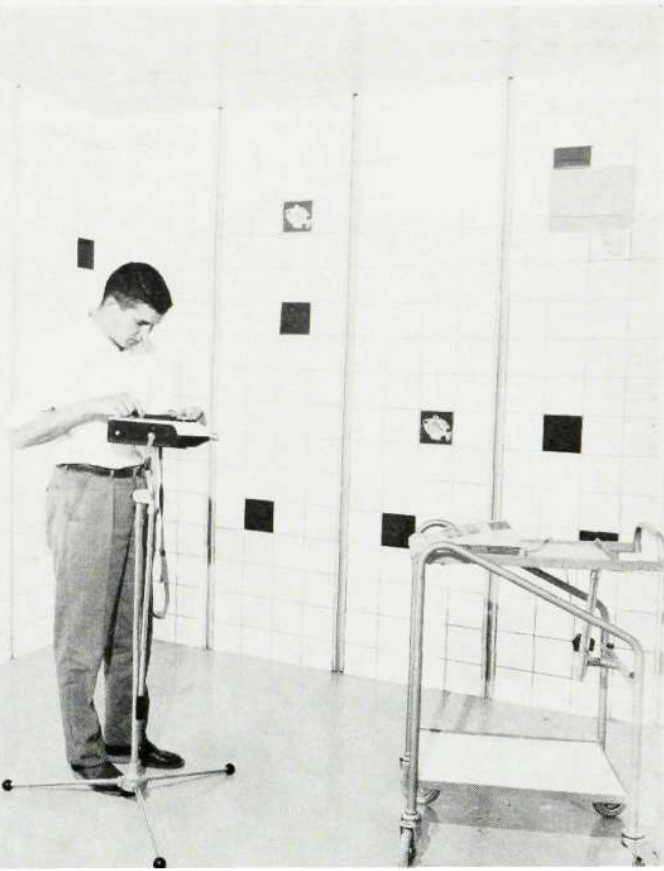
Mätningar av L M Ericssons Dirivox-apparat i ekorummet.
