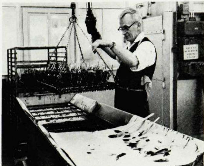
Gustav Berglund i färd med impregnering av transformatorer på avdelning 851.
