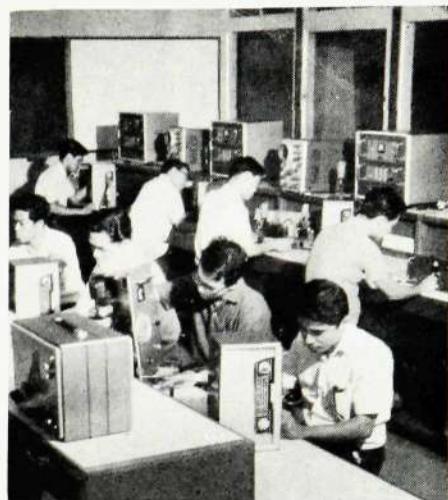
Eleverna under arbete med trimning och kontroll av radiomottagare i övningsrummet.
