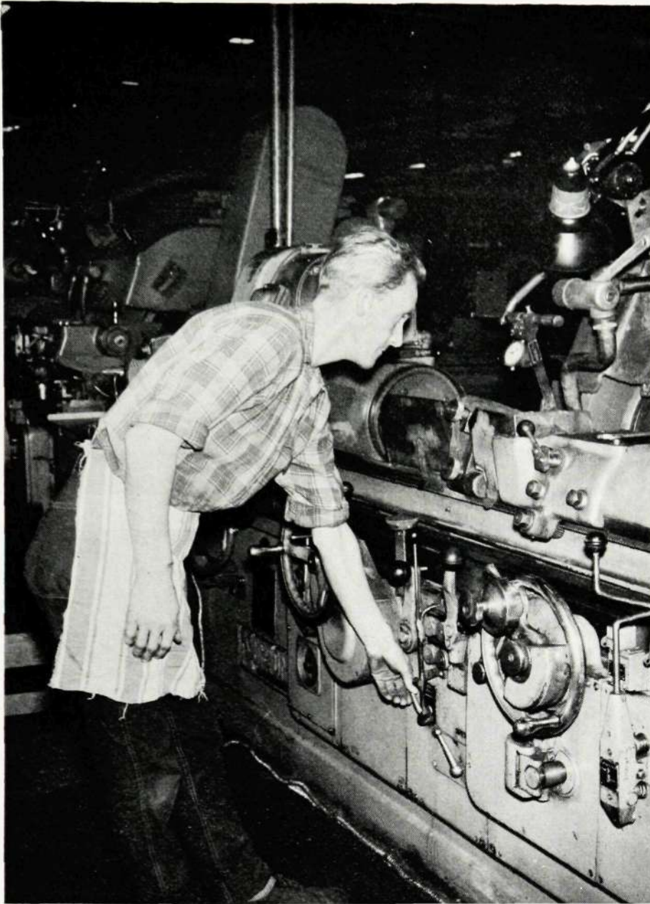
Med en enkel åtgärd, t. ex. en förlängd spak eller högre placerad maskin, skulle man kunna spara den här mannens rygg. Försök att ordna arbetet lättare så mär ni bättre och jobbar effektivare. Obs! Gäller även alla på kontor.
