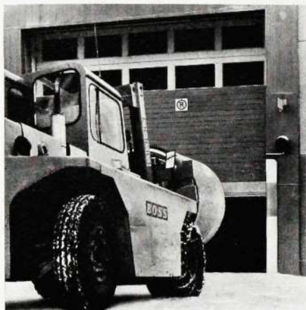
Sesam gör bl.a. att man kan sitta kvar i fordonet och trycka på en knapp för att öppna och stänga en port. I mitten sändaren som sitter på fordonet, t.h. mottagaren placerad vid porten.
