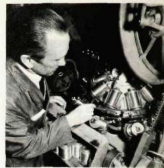
Förman Sigvard Sandberg, KV/Vt 13 , pekar på en löpare i en Wardwell flätmaskin. Genom att förändra löparens läge knipsas inte längre trådarna av.
