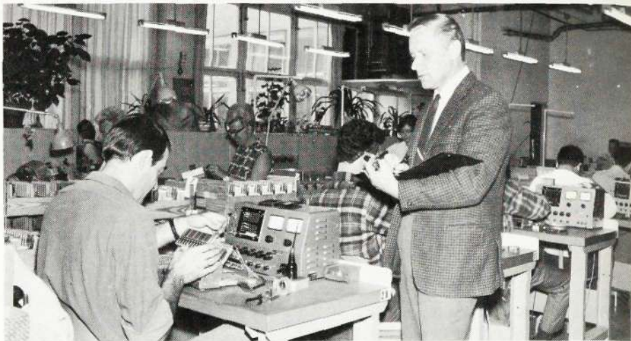
Herr Kostic Predrag, HF/Vt 39, får sitt arbete tidsstuderat av arbetsstudieteknikern Birger Johansson. Det är en klockstudie för ackordsättning av arbetet med justering av multiplexkopplingsreläer.
