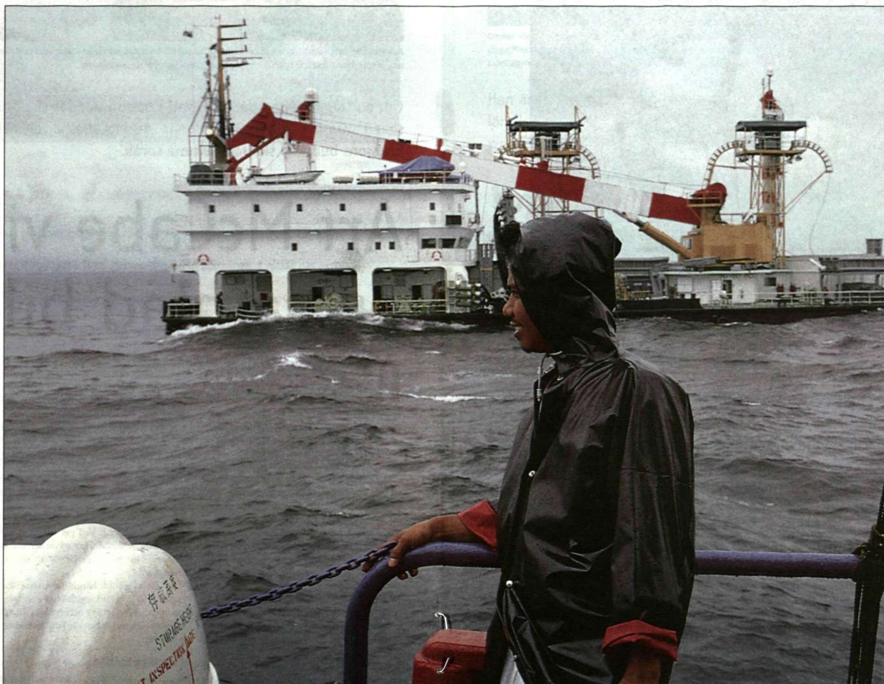
Det specialbyggda kabelfartyget Networker lägger sjökabel på 40 meters djup i Siambukten. Ett stort stålsvärd ställs mot botten, som med hjälp av en vatteninjektor spolar en ränna på 1,5 meter ner i sjöbotten. Metoden innebär att sand och grus skjuts undan samtidigt som kabeln läggs ned. Arbetet övervakas av dykare, som också utför precisionsarbete när kabeln korsar gasledning eller andra kablar samt löser problem med exempelvis undervattensklippor. Kabeln är under installationen kopplad till en testutrustning för kontinuerlig övervakning. Foto: Lars Åström
