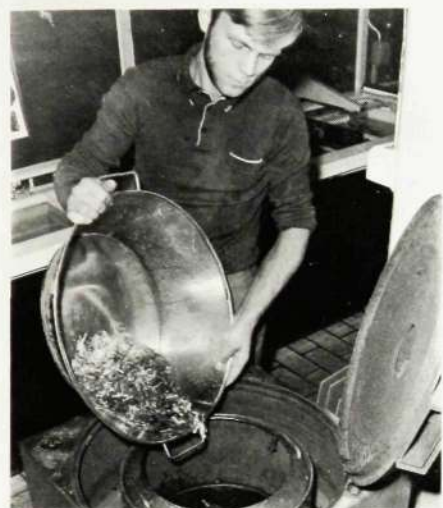
Jan Kull torkar här de förgyllda gaffelkontaktarna i en centrifug.
