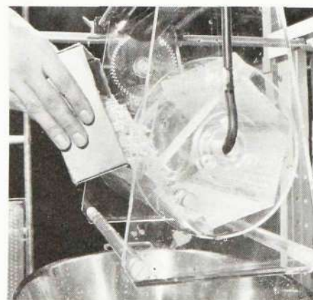
Ovan: En förgyllningsmaskin av typ Modul-X är sedan några veckor i kontinuerlig drift på HF/Vt 16. Nedan: Materialet som ska förgyllas läggs i en trumma av plast. Trumman förs sedan automatiskt vidare genom anläggningens olika bad. T. h.: Trumman har just kommit upp ur förgyllningsbadet. Det nästan rena guldet (97 procent) hänger i form av anoder vid behållarens kanter.
