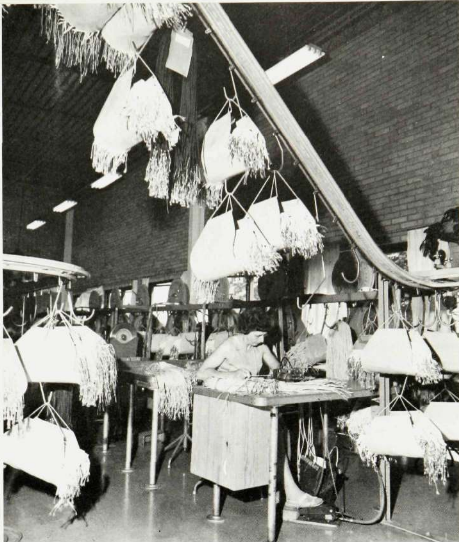
Telefonsnöravdelningen i Vedeby. Ett sinnrikt arrangerat transportsystem löper genom hela avdelningen. Personalen består med några få undantag av enbart kvinnor till skillnad mot trådtrageri och lackering där arbetskraften — med några få undantag — uteslutande är manlig. Fru Margit Karlsson håller på med att sätta hylsor på telefonsnören.
