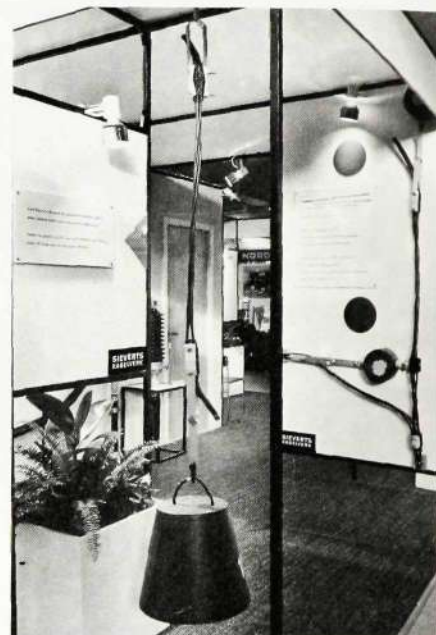
Denna hängkabel, ALUS, är belastad med en tusenkilos vikt. Den har under 50 dygn inte glidit i fästena, som är av SKV:s patenterade konstruktion.
